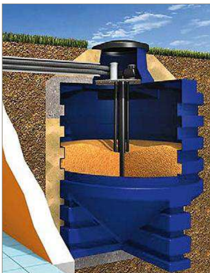
Abb. 17: Erdlager aus Kunststoff mit senkrechter Förderschnecke
