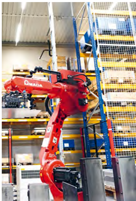
Effizient Der Workflow umfasst sechs bis neun Stationen. Ein Roboter transportiert die schweren Bauteile.
