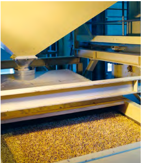
Im Pelletwerk Die frisch gepressten Energiebündel werden vor der Auslieferung gesiebt.
